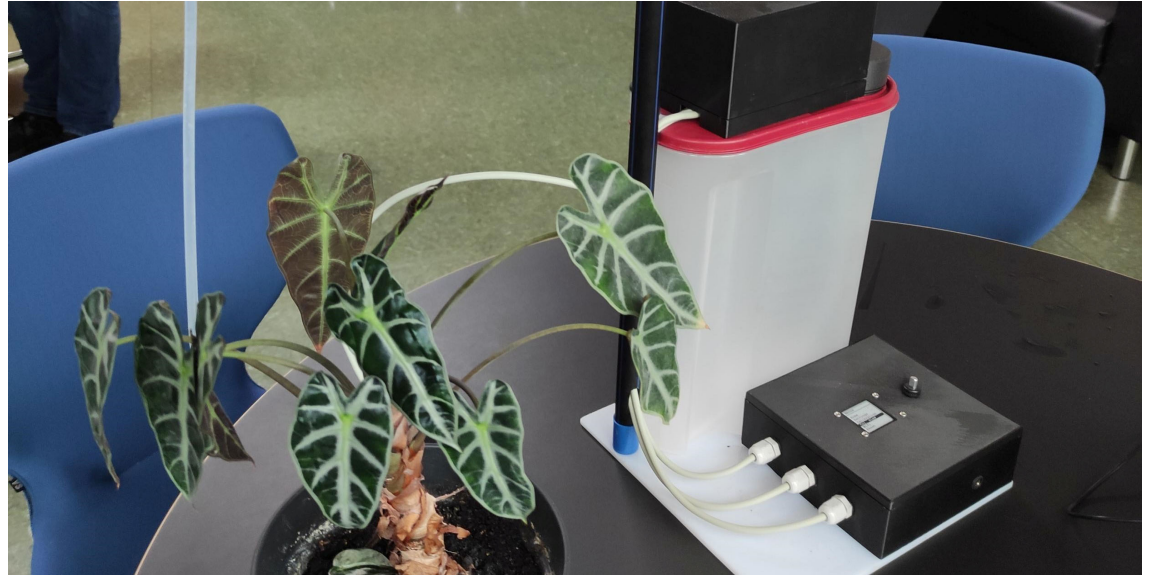
Aufbau der Bewässerungsanlage
